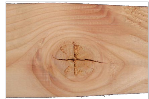
Foto 11 - Cretti a stella formati a seguito della perdita di umidità in un nodo sano aderente su elemento di douglasia.
