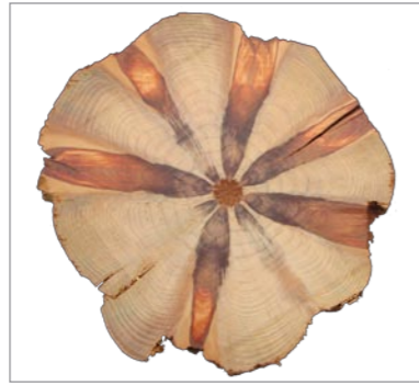
Foto 10 - Nodi disposti a verticillo in tronco di pino.
