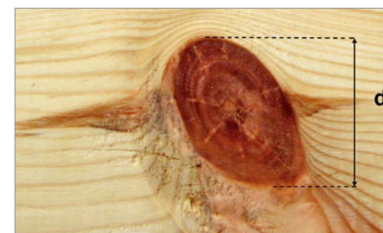
Foto 8 - Esempio di misurazione secondo il "metodo alternativo", indicato per legname strutturale, di un nodo sano aderente su elemento di pino laricio.
