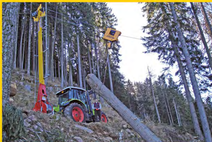
V400/2T: tiro da 2 a 3 t; velocità 3÷4,5 m/sec.
