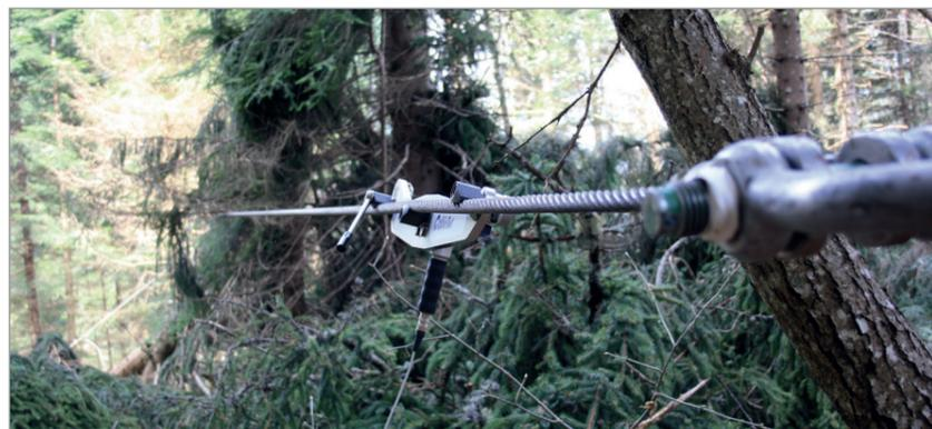
Foto 1 - Trave dinamometrica per il monitoraggio delle tensioni installata su una fune portante in prossimità dell'ancoraggio.
