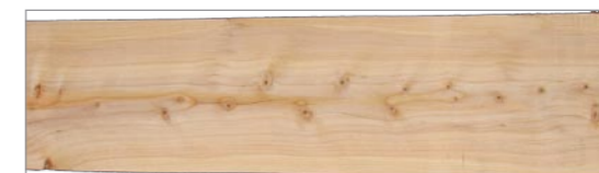
Foto 12 - Tavola di cipresso con nodi concentrati nella parte centrale.
