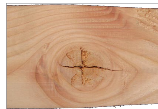
Foto 11 - Cretti a stella formati a seguito della perdita di umidità in un nodo sano aderente su elemento di douglasia.
