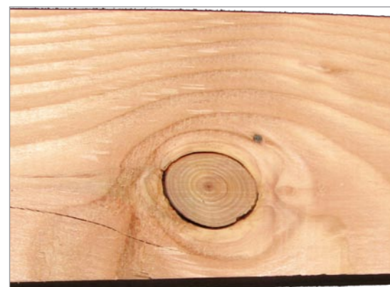
Foto 4 - Nodo non aderente su travetto di douglasia.
