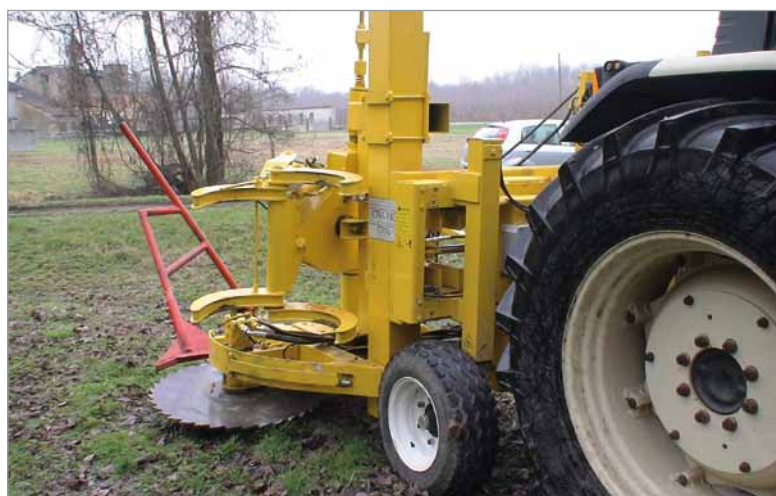
Foto 1 - Abbattitrice andanatrice per pioppo quinquennale: sono visibili il disco di taglio e la doppia pinza a posizionamento variabile.
