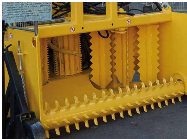
Foto 2 - Testata pick up : sono visibili il dispositivo pick up , i rulli di convogliamento e i rulli di alimentazione.
