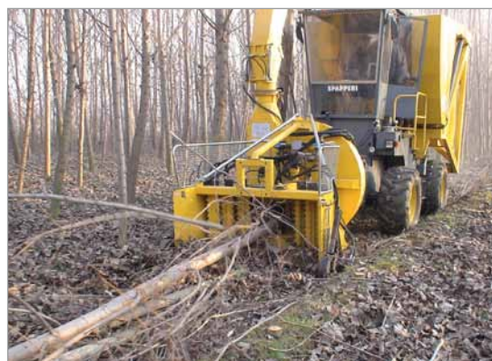
Foto 3 - Cippatrice semovente in raccolta di pioppo quinquennale andanato.
