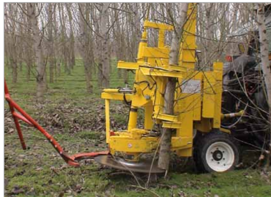
Foto 2 - Abbattitrice andanatrice per pioppo quinquennale durante la fase di rilascio della pianta in andana.
