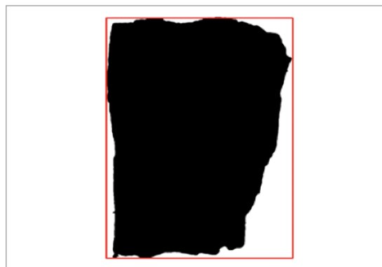
Foto 2 - Esempio di immagine di scaglia restituita dopo il processo di binarizzazione.
