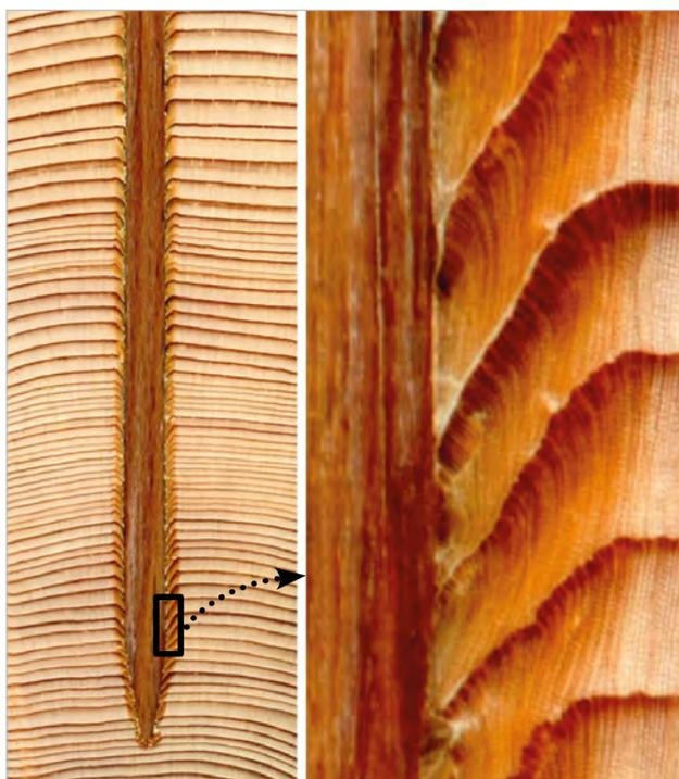
Immagine di una sezione di chiodo di legno LignoLoc®, inserito in un elemento di legno di abete, e il particolare della zona di saldatura. Tratto dalla pubblicazione ["Wood nails to fix softwoods: characterization of structural deformation and lignin modification"](#) in *European Journal of Wood and Wood Products* (2018) 76:979-988.
